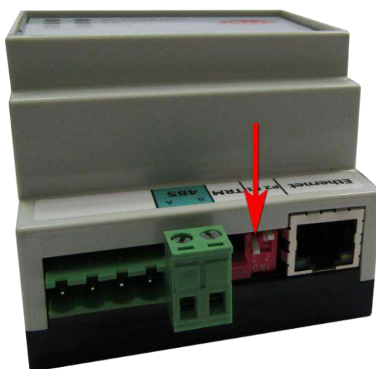
Рисунок 14. Установка движкового переключателя 1 в положение ON .
