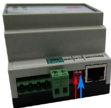
Рисунок 41. Установка движковых переключателей в положение OFF
